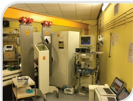
Caméra d'émission positronique en configuration pour la mesure de la sensibilité régionale à l'insuline
